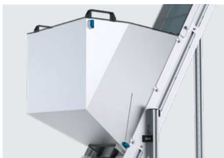
Tolva-depósito con sensores de nivel de llenado
