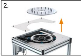
2. Eingreifschutz und Mitnehmerplatte entfernen
