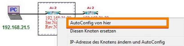
6) Les contrôleurs sont maintenant configurés (attention : les moteurs tournent à titre de test). La configuration est terminée lorsque les moteurs ne tournent plus et que la LED au-dessus du symbole "crochet" clignote à nouveau en **vert**.
