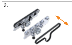
9. Seitenteil entfernen und Riemen tauschen
