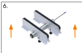
6. Riemenschwerters und Motorrolle herausheben
