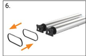
6. Remplacer les courroies Poly-V
