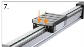
7. Serrer uniformément les deux vis du tendeur de courroie et tendre la courroie à 32 Hz (longueur de référence 1 m).
