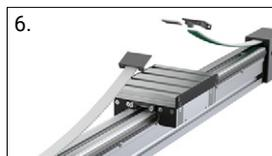
6. Monter le tendeur de courroie crantée et serrer à nouveau le système de tension de courroie
