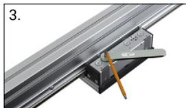
3. Fixer l'excentrique avec le contre-écrou et la clé excentrique correspondante
