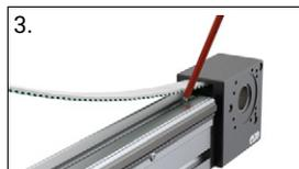
3. Desserrer les vis de fixation d'une des roues de renvoi
