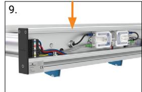
9. Fixer les écrous hexagonaux (et, le cas échéant, les raccords de couple) sur la sortie de câble (50 Nm)
