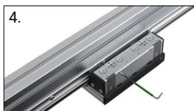
4. Serrer la vis sans tête pour fixer l'écrou excentrique.
