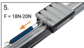
5. Vérifier le bon fonctionnement des chariots. Faire les réglages sans courroie montée sur le chariot !
