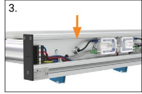
3. Desserrer les écrous hexagonaux et retirer les bras de couple le cas échéant (uniquement pour les rouleaux moteurs)
