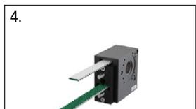
4. Retirer et remplacer la courroie
