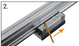
2. Amener le rouleau excentrique contre le rail de guidage sans exercer de force jusqu'à ce que l'ensemble du chariot de guidage n'ait plus de jeu.
