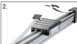
2. Retirer le tendeur de courroie crantée
