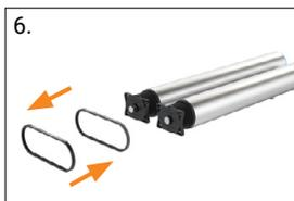
6. Sostituire le cinghie Poly-V
