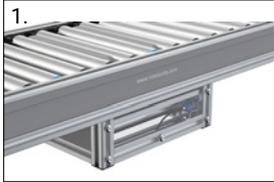
1. Smontare l'unità di trasferimento a 90° rimuovendola dalla rulliera motorizzata
