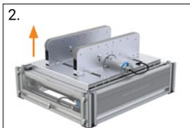
2. Allentare le viti di fissaggio del binario cinghia e il dado di fissaggio del rullo motorizzato; rimuovere il rullo motorizzato assieme al binario cinghia
