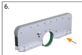
6. Rimontare il pannello laterale e fissare le viti di fissaggio
