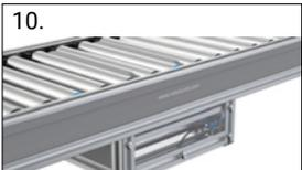
10. Montare l'unità di trasferimento a 90° posizionandola sulla rulliera motorizzata
