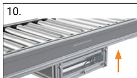
10. Montare l'unità di trasferimento a 90° posizionandola sulla rulliera motorizzata
