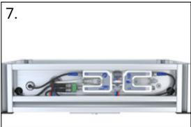
7. Installare il rullo motore / rullo tendicinghia e fissarlo su entrambi i lati.
