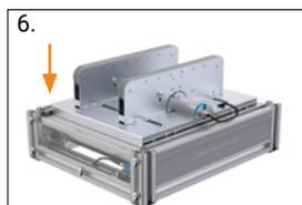
6. Posizionare il rullo motorizzato assieme al binario cinghia, serrare il dado di fissaggio del rullo motorizzato (50 Nm) e le viti di fissaggio
