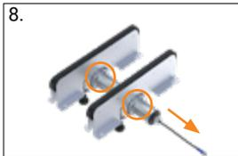
8. Allentare gli anelli di serraggio e smontare il rullo motorizzato da sostituire
