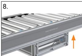
8. Monter l'unité de transfert à 90° sur le convoyeur à rouleaux motorisés
