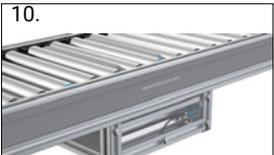
10. Montez l'unité de transfert à 90° sur le convoyeur à rouleaux motorisés
