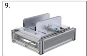
9. Placez l'unité de levage, y compris le porte-courroie, sur les racks de base
