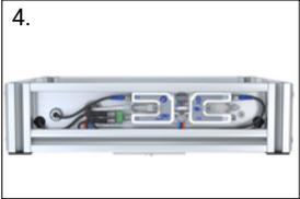
4. Desserrer et démonter le rouleau moteur / le rouleau porteur des deux côtés
