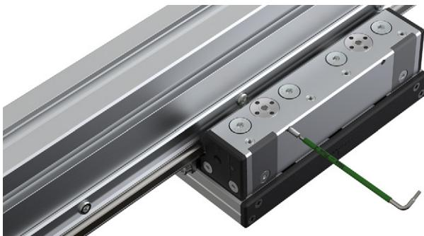
4.3.2. Grâce à la clé Allen, laisser reposer le rouleau excentrique sans pression sur la piste de guidage.
