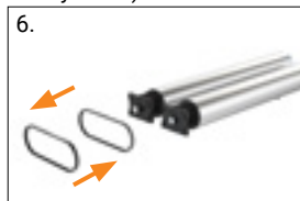
6. Výměna poly-V řemene
