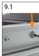
9.1 Upevněte šestihranné matici (motorový válec = 50 Nm)
