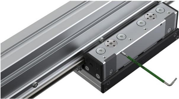
4.3.2. Mit dem Imbusschlüssel die Excenterrolle ohne Kraftaufwand an der Führungsbahn anstehen lassen.
