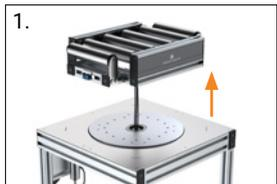
1. Retirer le convoyeur à rouleaux motorisés et le câblage
