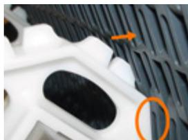
Nel caso di tappeti modulari Flush Grid, controllare il corretto inserimento del pignone dalla superficie del tappeto.
