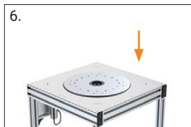
6. Rimontare protezione dita e piastra trascinamento
