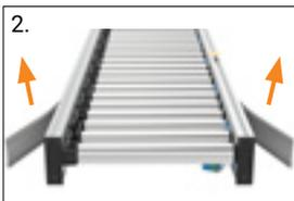
2. Retirar las cubiertas para perfiles de ambos lados
