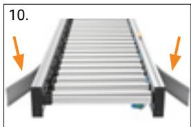
10. Montar las cubiertas para perfiles
