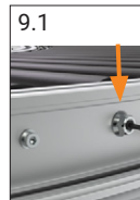
9.1 Sechskantmuttern befestigen (Motorrolle = 50 Nm)
