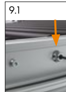
9.1 Sechskantmuttern befestigen (Motorrolle = 50 Nm)
