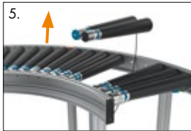
5. Rollen aus der Aufnahme heben
