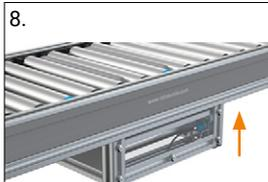
Eckumsetzer am Rollenförderer montieren
