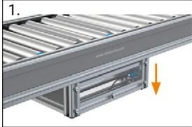
Eckumsetzer vom Rollenförderer demontieren
