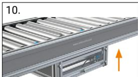
10. Eckumsetzer am Rollenförderer montieren
