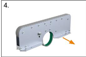
4. Befestigungsschrauben des Seitenteils lösen und Seitenteil entfernen
