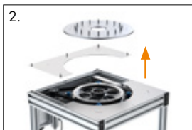
2. Eingreifschutz und Mitnehmerplatte entfernen
