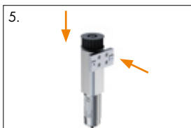
5. Zahnriemenscheibe und Motorplatte am Motor befestigen
