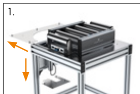
1. Eingreifschutz motorseitig demontieren
