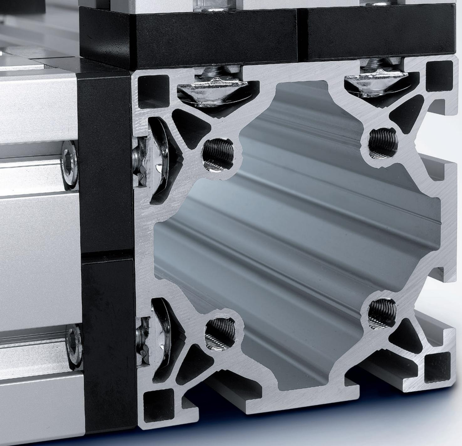
„Tragendes“ Element des Automatisierungsbaukastens ist die einzigartige Profil- und Verbindungstechnik. Zwei miteinander kombinierbare Profilgrößen im 40er und 50er Raster, sowie eine dazu passende und in allen Profilen einheitliche Nutgröße von 14 mm, eröffnen eine Vielzahl an Möglichkeiten in der Automatisierungstechnik.
