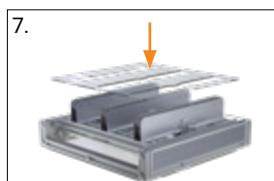
Posizionare e avvitare il supporto per cinghia, l'albero di collegamento e il coperchio
