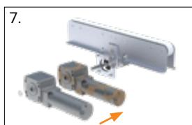
Estrarre e sostituire il motore
