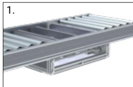
Rimuovere i rulli della rulliera situati sopra l'unità di trasferimento 100
