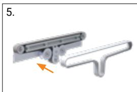
Sostituire la cinghia e, se necessario, le pulegge
