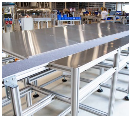
Banco da lavoro con nastro trasportatore a tappeto integrato
