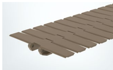
Larghezza della catena 190,5 mm | raggio della curva 400 mm
