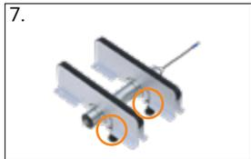
7. Allentare la tensione del nastro trasportatore
