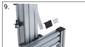
9. Monter et fixer le tendeur de courroie en haut et en bas
