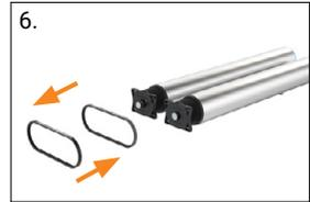
6. Remplacer les courroies Poly-V
