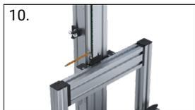
10. Serrer uniformément les vis du tendeur de la courroie
