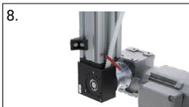
8. Serrer les vis de fixation du rouleau de renvoi inférieur
