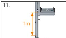
11. Tendre la courroie à 36 Hz sur 1 m (charge comprise)
