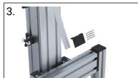
3. Retirer le tendeur de courroie en haut et en bas
