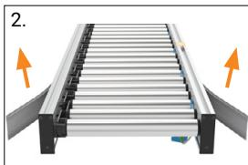
2. Retirer les profils de recouvrement des deux côtés
