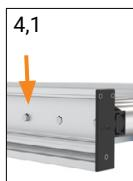
4.1 Pousser l'axe à ressort en direction du rouleau jusqu'à la butée
