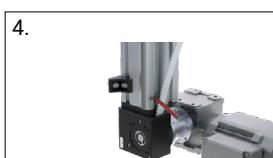
Desserrer les vis de fixation du rouleau de renvoi inférieur
