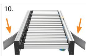
10. Monter les profils de recouvrement
