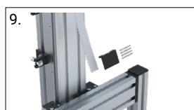
Monter et fixer le tendeur de courroie en haut et en bas
