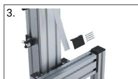
Retirer le tendeur de courroie en haut et en bas
