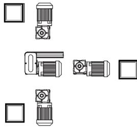
Position du boîtier de raccordement :
