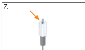
Retirer le moyeu excentrique et remplacer le moteur
