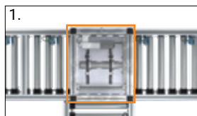
1. Retirer les vis et le carter
