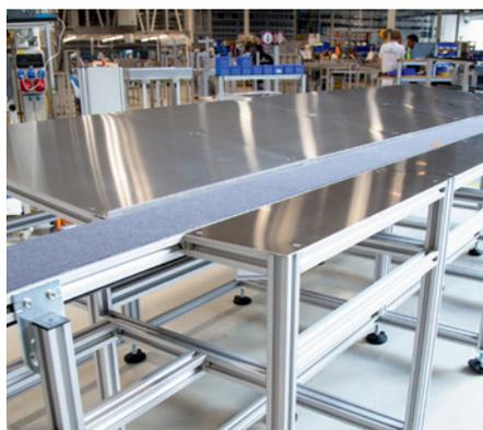
Poste de travail avec convoyeur à bande intégré
