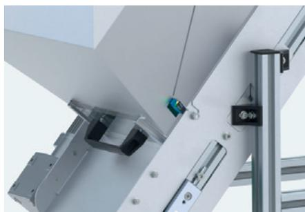
Réservoir avec capteurs d'indication de niveau
