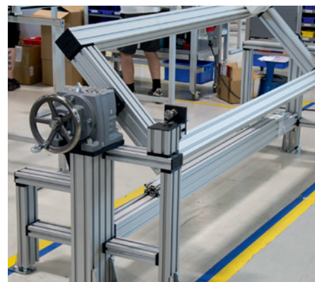
Banco de trabajo inclinable mediante manivela
