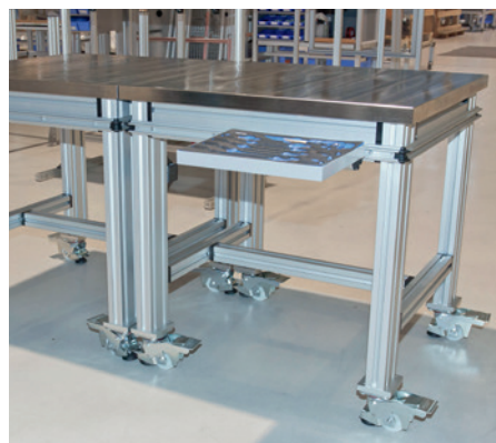
Banco de trabajo para cargas pesadas con tablero de acero inoxidable
