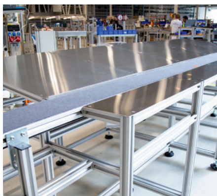
Banco de trabajo con transportador de banda integrado
