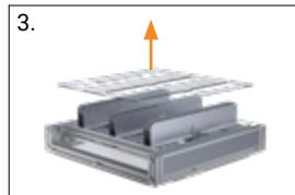
3. Retirar el soporte elevable de cinta, la cubierta y el eje de conexión
