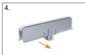
4. Aflojar los tornillos de fijación del panel lateral y retirar el panel lateral
