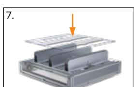
7. Colocar y atornillar el soporte elevable de cinta, el eje de conexión y la cubierta
