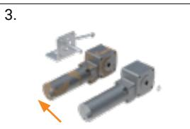
Quitar el circlip, desmontar y cambiar el motor 1
