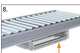
8. Volver a colocar los rodillos del transportador de rodillos
