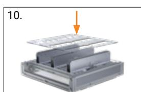
10. Colocar y atornillar el soporte elevable de cinta, el eje de conexión y la cubierta
