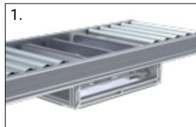
1. Retirar los rodillos del transportador situados encima de la unidad de transferencia perpendicular
