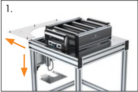
1. Desmontar la protección contra el atrapamiento del lado del motor
