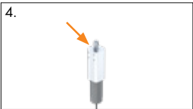
4. Retirar el cubo excéntrico y cambiar el motor
