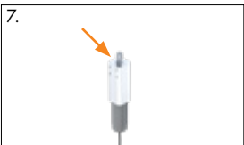
7. Retirar el cubo excéntrico y cambiar el motor
