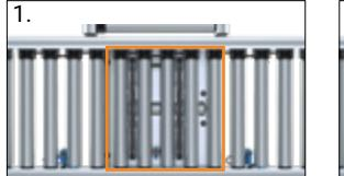
Retirar los rodillos en la zona del sistema de transferencia perpendicular
