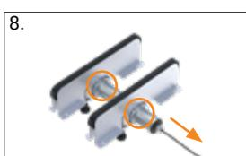
Aflojar los anillos tensores y retirar el rodillo motorizado
