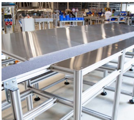
Pracovní stůl s integrovaným pásovým dopravníkem
