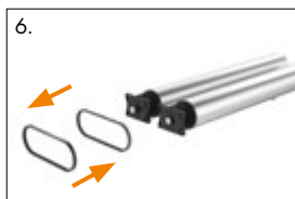
6. Výměna poly-V řemene
