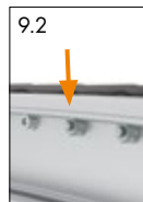
9.1 Upevněte šestihranné matice (motorový válec = 50 Nm)
