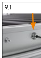
9.1 Upevněte šestihranné matice (motorový válec = 50 Nm)
