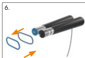
6. Výměna poly-V řemene
