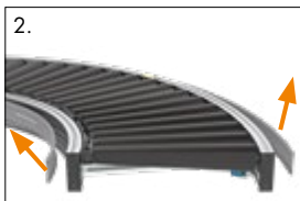
2. Odstraňte krycí profily na obou stranách
