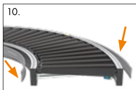
10. Namontujte krycí profily
