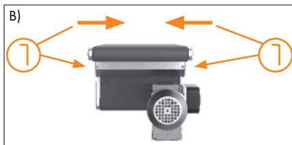
Pás vede vpravo, utáhněte jej vlevo. Řemen vede vlevo, utáhněte jej vpravo.
