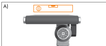
Seřízení pásového dopravníku
