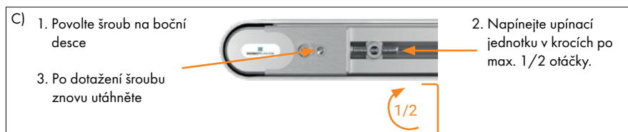
Pás vede vpravo, utáhněte jej vpravo. Pás vede vlevo, utáhněte jej vlevo
