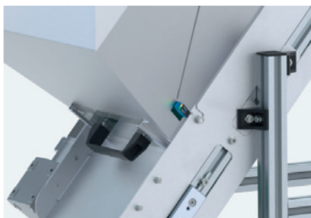
Zásobník s ukazatelem hladiny-senzory
