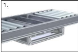
1. Die über dem Eckumsetzer liegenden Rollen des Rollenförderers entfernen
