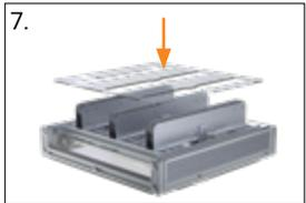
7. Riemenschwert, Verbindungswelle und Abdeckung positionieren und verschrauben
