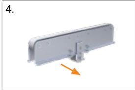
4. Befestigungsschrauben des Seitenteils lösen und das Seitenteil entfernen
