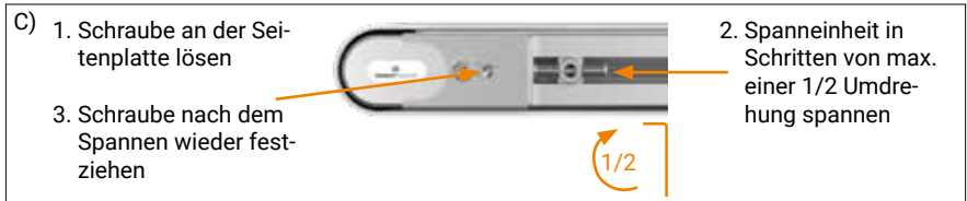
Gurt verläuft nach rechts, rechts spannen Gurt verläuft nach links, links spannen
