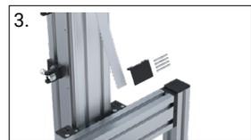
3. Riemenspanner oben und unten entfernen
