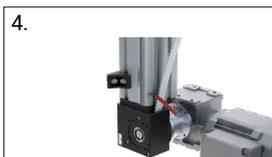
4. Befestigungsschrauben der unteren Umlenkung lösen
