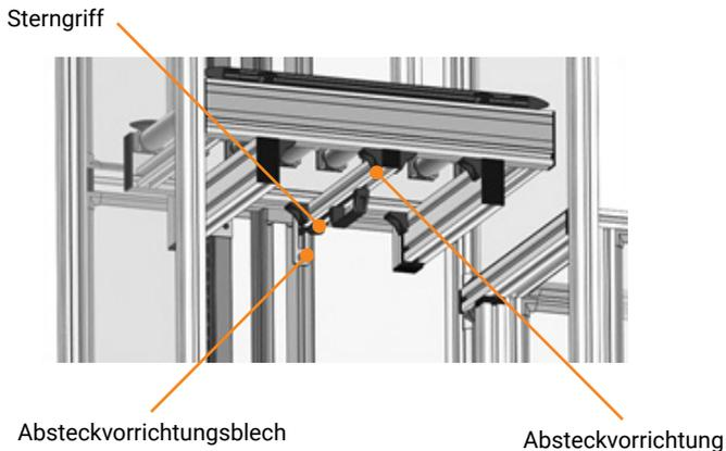
Wenn die Wartungsposition aus irgendwelchen Gründen nicht angefahren werden kann, z. B. Versagen der Steuerung, muss der Laufwagen anderweitig gesichert werden (z.B. Aufhängen oder Unterstellen).
