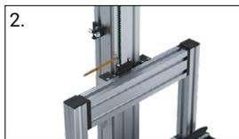
2. Riemenspannsatz oben und unten lösen
