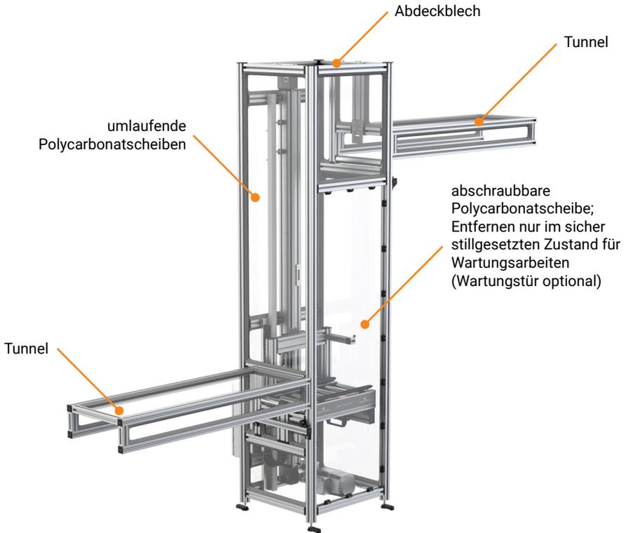
Beim Einbauen bzw. beim Komplettieren zu einer Anlage, muss die „Integration der Sicherheit“ beachtet werden. Der Integrator ggf. Betreiber hat dafür zu sorgen, dass weitere geeignete Schutz- und Sicherheitseinrichtungen realisiert werden.
