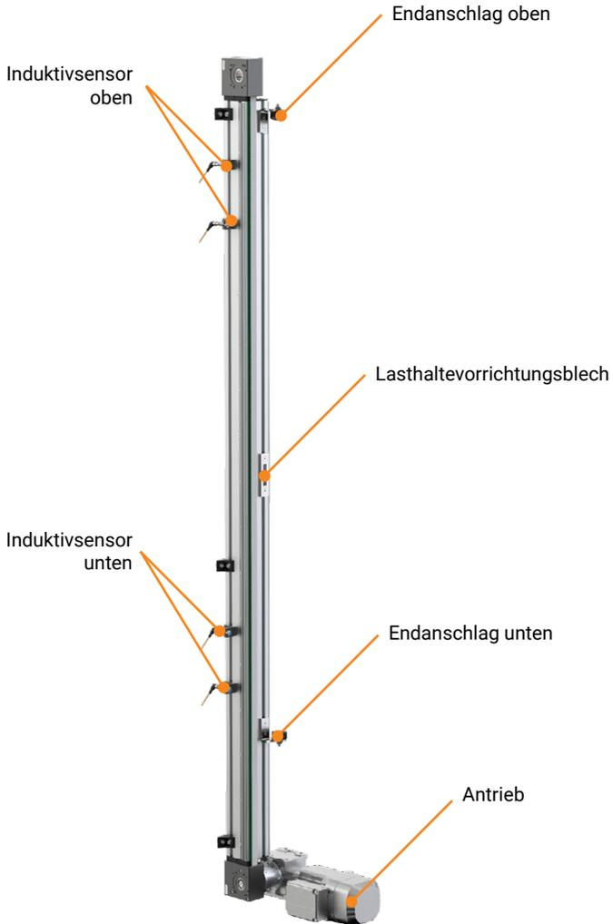
Die Last wird nur indirekt über die Motorbremse gehalten. Bei einem Bremsversagen fällt der Laufwagen im Heber nach unten. Ein Bremsentest („Brake Proof Test“) ist nicht vorgesehen.
