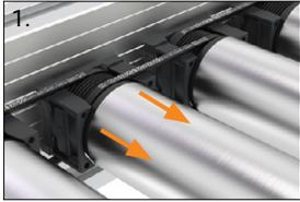
1. Schutzelemente entfernen
