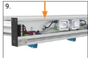
9. Sechskantmutter und (ggf. Drehmomentstütze) am Kabelauslass befestigen (50 Nm)
