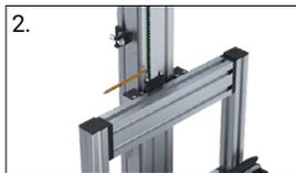
2. Riemenspannsatz oben und unten lösen
