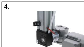
4. Befestigungsschrauben der unteren Umlenkung lösen
