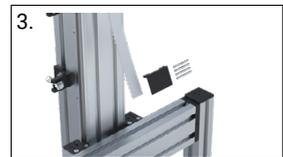
3. Riemenspanner oben und unten entfernen
