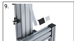
9. Riemenspanner oben und unten montieren und befestigen
