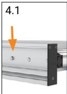
4.1 Federachse bis zum Anschlag in Richtung Rolle drücken
