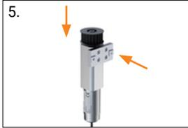
5. Zahnriemenscheibe und Motorplatte am Motor befestigen
