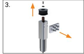
3. Zahnriemenscheibe und Motorplatte vom Motor entfernen
