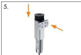
5. Zahnriemenscheibe und Motorplatte am Motor befestigen
