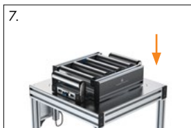
7. Rollenförderer befestigen und verkabeln
