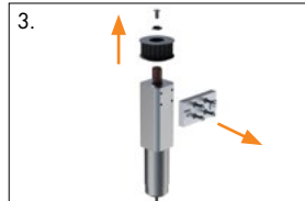
3. Zahnriemenscheibe und Motorplatte vom Motor entfernen
