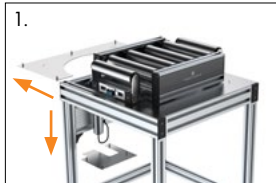
1. Eingreifschutz motorseitig demontieren
