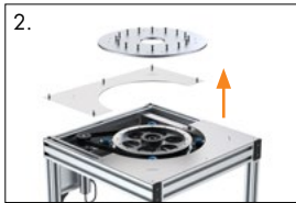
2. Eingreifschutz und Mitnehmerplatte entfernen
